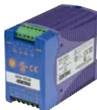
Montabile su guida DIN Adatto per sistemi ridondanti di 24 VAC max. 20 A Contatti a relè Diodi di disaccoppiamento LED indicatore di allarme per guasto in ingresso
